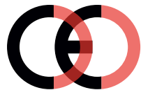
Falsche CE-Kennzeichnung (zu dicht)
