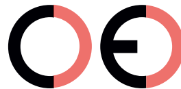
Falsche CE-Kennzeichnung (zu großer Zwischenraum)
